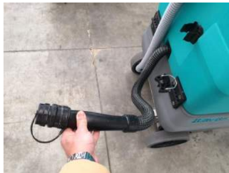
Tubo di scarico acqua sporca con controllo flusso (flow control)
